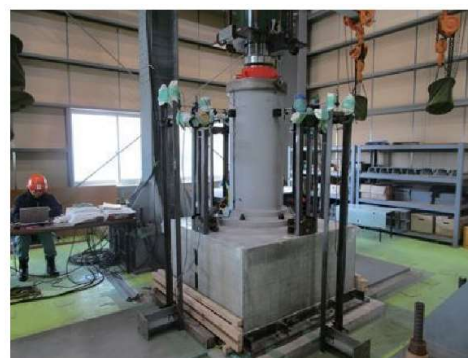
実物大の載荷実験状況(新型支承板の例)
